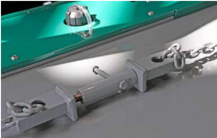
Figuur 5.13 | Borging ballastplaten – Prins Sprinter
