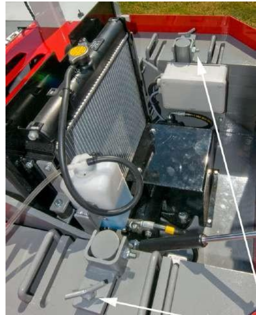
Figuur 5.14 | Borging ballastplaten – Prins Trike
